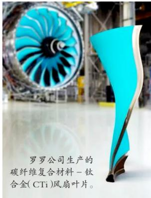
罗罗公司生产的碳纤维复合材料-钛合金（CTi）风扇叶片。
