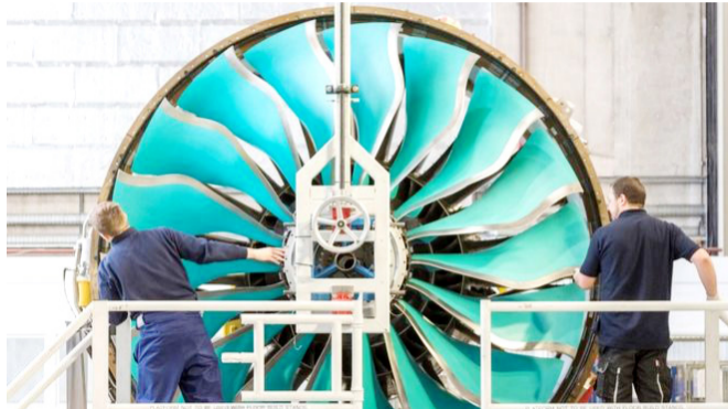
罗罗Ultrafan发动机碳纤维复合材料叶片和钛合金前缘。
