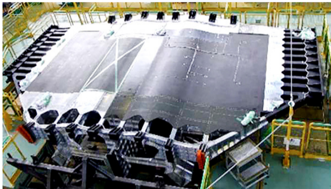
日本“未来战斗机”复合材料中机身强度试验模型。
