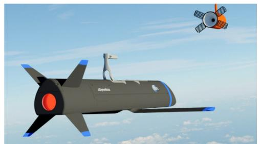
“小精灵”无人机的空中回收采用类似空中加油对接的技术，图为一架机正准备回收。
