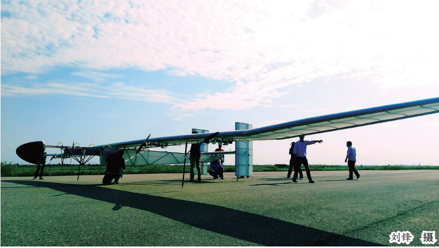
验证机，通过近两年对高效气动布局、柔性轻质结构和能源综合管理系统等关键技术的深化验证，以及自主飞行、全系统验证试飞、长航时试飞等试飞科目的持续开展，于2018年9月实现了长航时连续飞行。近期，通过大
