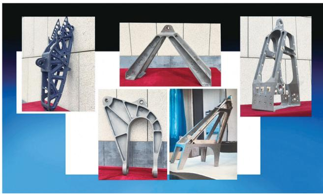
激光增材制造超大型整体钛合金框的纪录。这些大型3D打印件的装机应用，不仅为飞机结构带来显著的减重效果，
