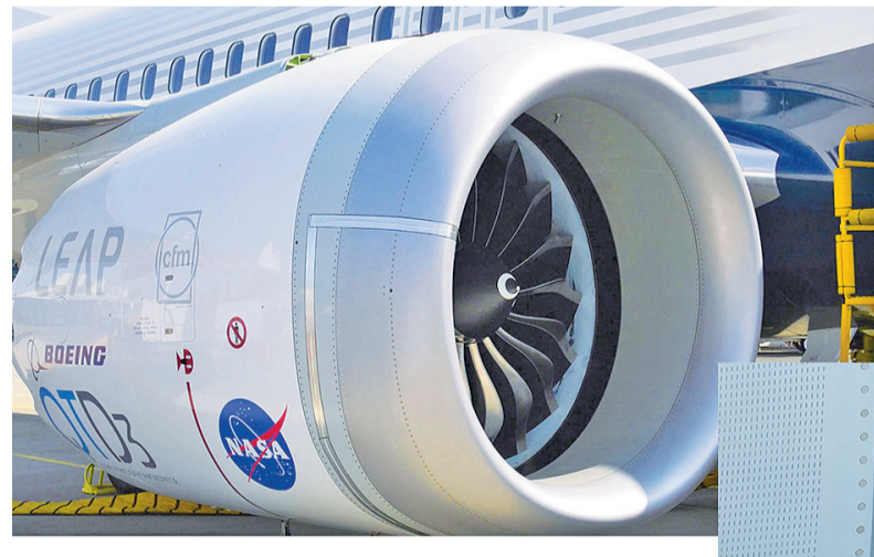
图中发动机短舱唇口的银带覆盖了进气口的噪声传感器(见图,新型低阻开槽面板)。
