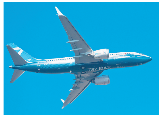
对波音737MAX-7低空飞越时标准Leap-1B发动机(右侧)慢车状态下噪声的测量。
