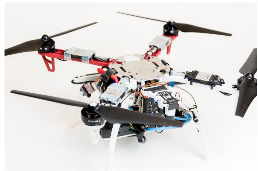
装有美国麻省理工学院 / 德雷珀实验室公司自主导航软硬件的四旋翼无人机。
