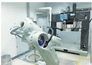
基于机械臂的柔性火焰筒皮秒激光精密制孔设备。
