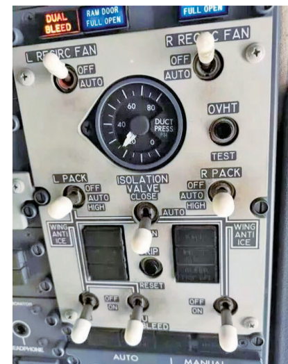
飞机空调组件控制面板：上方RECIRC FAN为再循环风扇，中间L PACK与R PACK为双组件。
