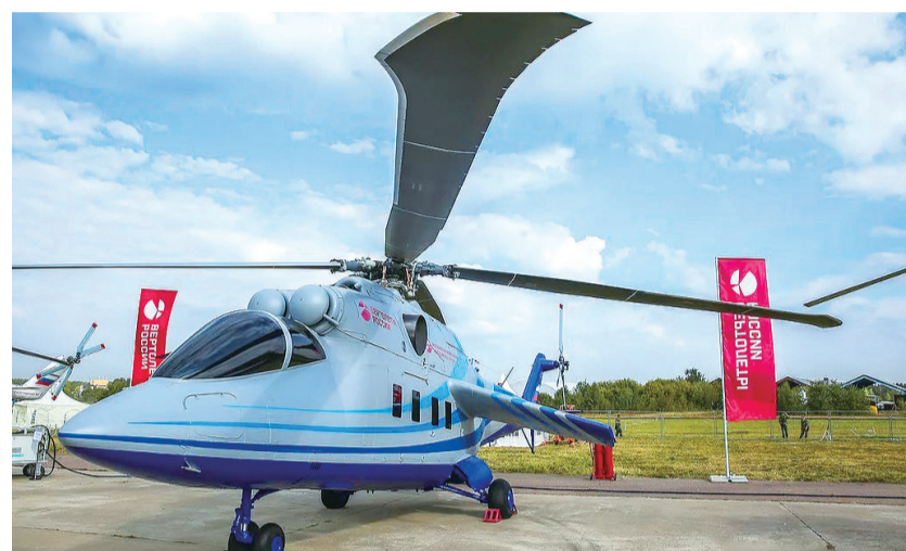
米-24LL PSV准备在2015年8月的莫斯科航展上展示，可以清楚地看到新旋翼桨叶的特点。
