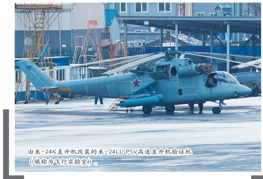
由米-24K直升机改装的米-24LL PSV高速直升机验证机（俄称为飞行实验室）。
