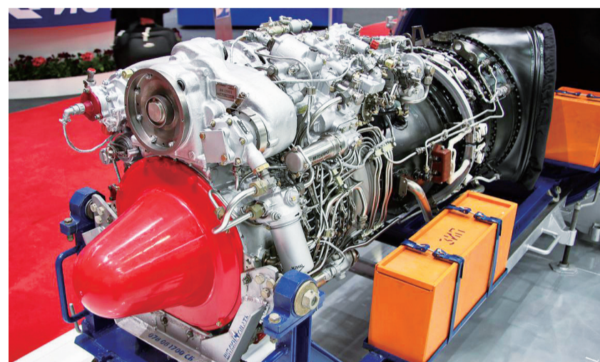
克里莫夫公司2011年展出的VK-2500涡轴发动机，该发动机配装米-24LL PSV验证机。按计划，该公司将以此为基础发展VK-2500M涡轴发动机，以配装高速直升机装备，并可用于改进俄现役米-28N和卡-52攻击直升机。
