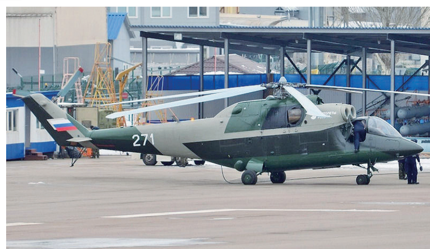
米-24LL PSV改装后并未加装推进装置，而是用2台克里莫夫设计局的VK-2500涡轴发动机替换了原来的TV3-117涡轴发动机，并采用了新的旋翼桨叶。俄联邦政府为该验证机的发展一共提供了6.3亿卢布（8500万美元）的经费，这包括对旋翼系统部件进行台架试验的费用。
