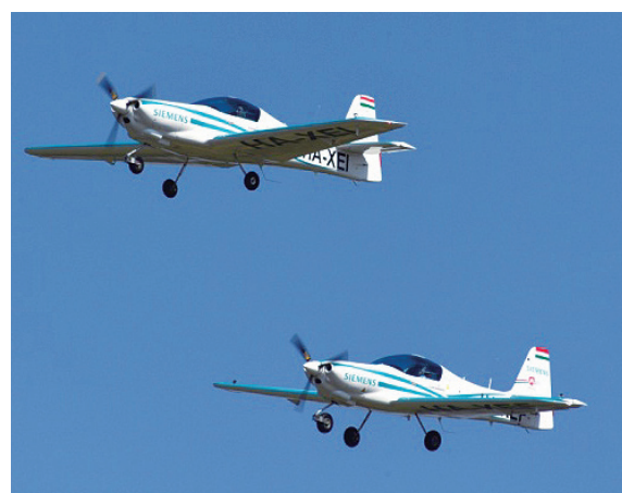
马格努斯飞机公司的2座混合eFusion飞机由柴油发动机和西门子电动机提供动力。
