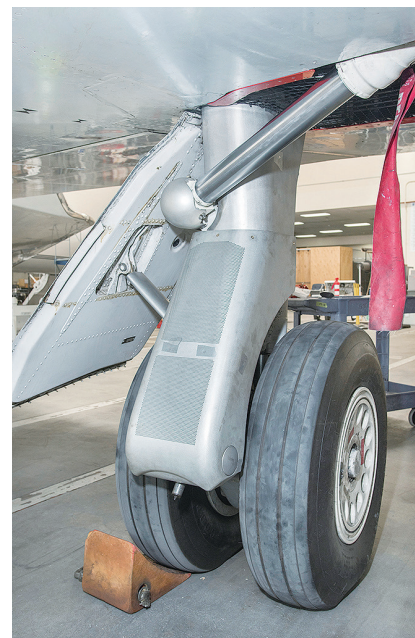
包含成千上万个小孔的起落架整流罩可降低压差，从而减小噪声。
