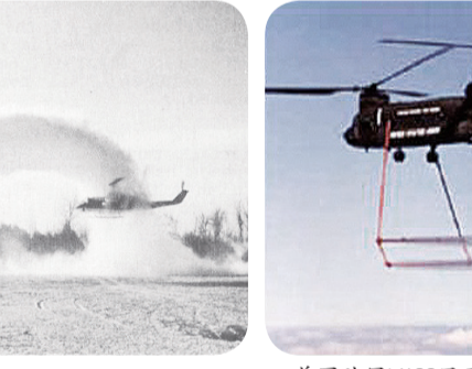
美国陆军HISS用于直升机和小固定翼飞机的结冰试验。
