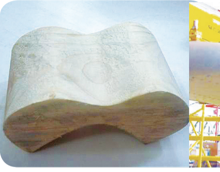
S-92直升机平尾的模拟冰型。
