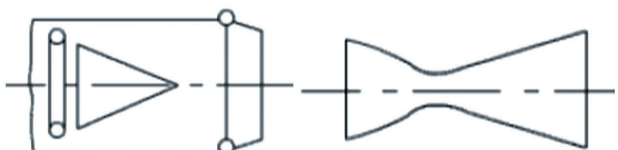
图1 收敛型喷管（左）与收敛扩张型喷管（右）。
