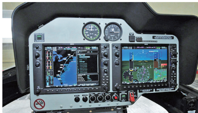
G1000H综合飞行驾驶舱已经应用于贝尔407GX i直升机上。
