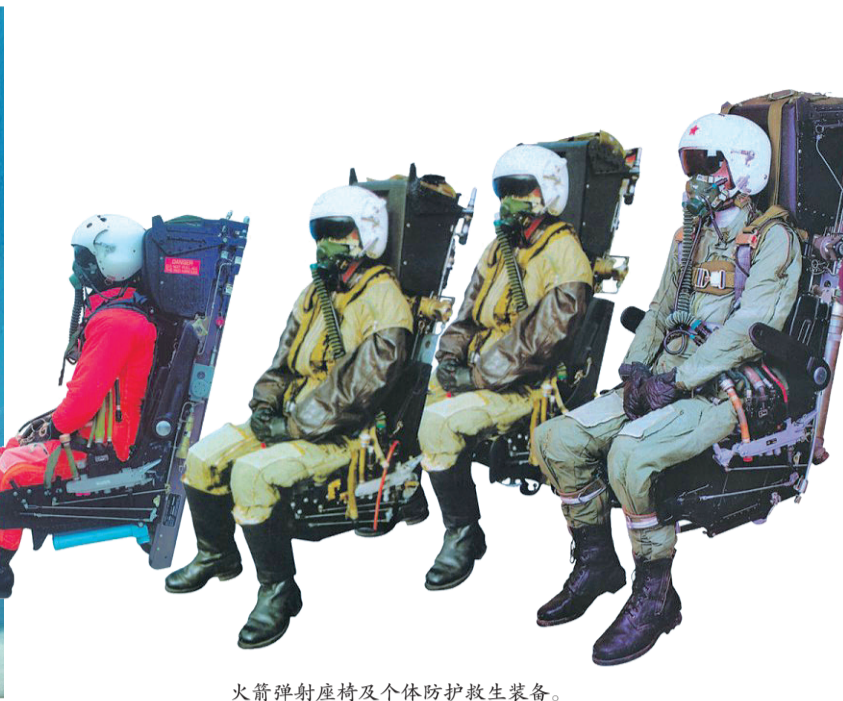
火箭弹射座椅及个体防护救生装备。
