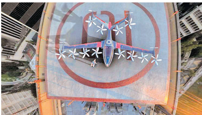
Joby航空2015年公布的S2飞机，该机在机翼和尾翼上共安装了12个倾转旋翼，在机翼和尾翼翼梢安装了4个推进桨。
