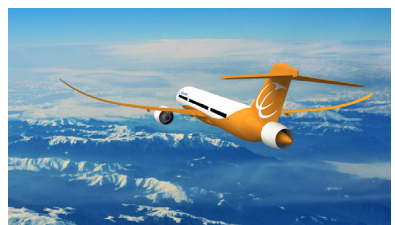
PFC概念是在欧盟Dispersal项目下开发的,采用尾部涡轮发动机驱动机身风扇的BLI布局。
