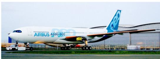
网络中灵活使用这两款机型。A330-800 和 A330-900 两种型号均配备了全新罗尔斯·罗伊斯遑达 7000 发动机, 拥有无缝进气道的全新发动机短舱、钛金属吊架、全新机翼和“空客飞行空间”客舱。A330neo 最明显的新特征是其专门研发的流线性翼尖鲨鳍小翼, 它应用了 A350XWB 的技术, 翼展延伸至 64 米。与上一代竞争机型相比, 航空公司将从降低 25% 的单座油耗、更低的维护成本和 A330 系列飞机市场领先的 99.5% 的运营可靠性中受益。
