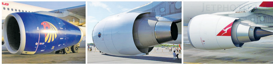
▲A330飞机可选装的三种发动机的喷管（左：遼达700；中：PW4000；右：CF6）。
