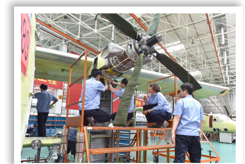
▲ 总装车间工人对运12飞机进行交付前的最后调整。
