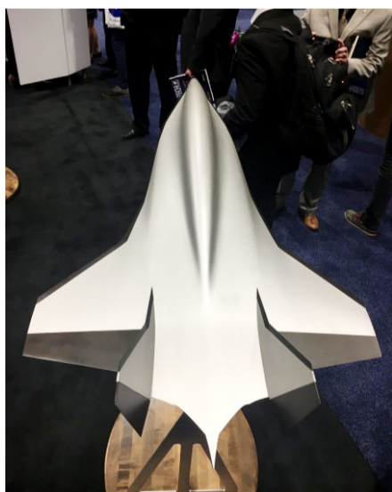
波音方案采用大后掠双三角翼无尾加双垂尾布局。
