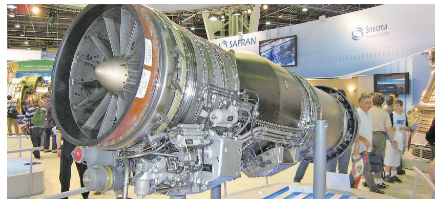
装有复合材料外涵机匣的欧洲M88-2型发动机。
