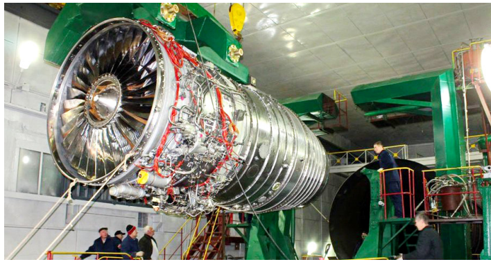
NK-32 02 发动机台架试车
