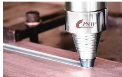
搅拌摩擦焊搅拌针工作中。
