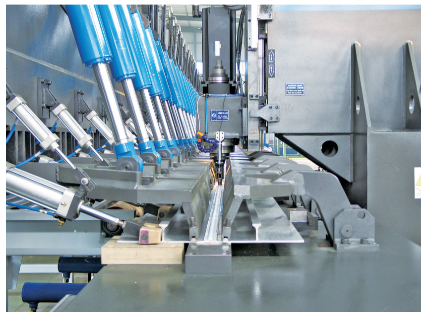
搅拌摩擦焊设备。
