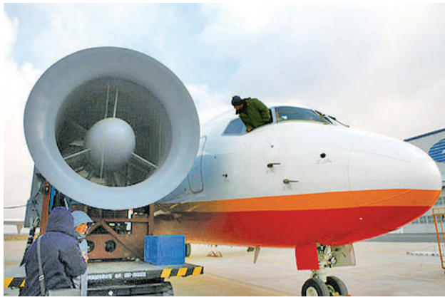
ARJ21-700结冰条件下短舱防冰系统机地上地面试验。
