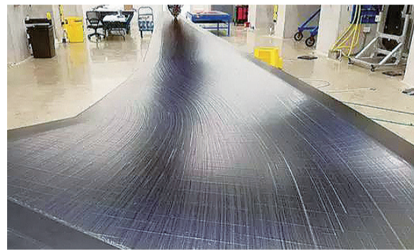
机翼蒙皮的纹理展示了由自动化纤维铺放头沿着弯曲路径进行碳纤维牵引铺放的结果。
