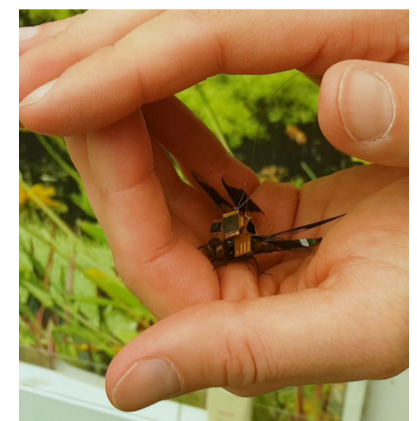
德雷珀公司带有电子背包的“蜻蜓眼”无人机。
