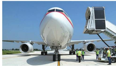
日前，由法国空客总部图卢兹起飞的空客A330“绿皮飞机”，安全平稳地降落在天津机场。这标志着天津机场历经17个月的沟通、谈判和精心准备，终于迎来了首班空客“绿皮飞机”。“绿皮飞机”是指飞机在完成总装之后，可以安全飞行但未安装客舱设施和喷漆的飞机，由于其机体材料表面喷涂了绿色的防腐漆而呈现出绿色。未来，空客完成及交付中心将完成该“绿皮飞机”的后续工作，包括飞机接收、客舱安装、飞机喷漆、飞行测试以及飞机交付和客户接收等环节。今后，每月至少将有1~2架空客A330型“绿皮飞机”被运往天津。这也标志着今年天津将成为空客在欧洲以外第一个能够同时交付窄体和宽体客机的航空中心。
