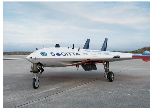
空客旗下子公司——空中客车防务及航天公司正在通过其Sagitta项目来开发无人机并进行系列量产。为实现这一目标，该公司近日在南非奥弗贝格对Sagitta演示验证无人机进行了首次试飞。这款演示验证无人机采用喷气推进，成功自主飞行约7分钟。据悉，空中客车防务及航天公司与慕尼黑理工大学、慕尼黑联邦国防军大学、英戈尔施塔特应用技术大学、开姆尼茨工业大学及德国航空航天中心共同合作研发了这种新型无人机。这款演示验证机只有Sagitta的1/4，机长3米，翼长3米，最大起飞重量为150千克。其选择了典型的固定翼设计，机身由碳纤维复合材料制成。
