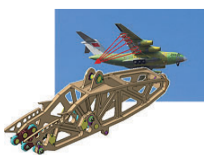
图1 运20飞机主襟翼滑轨架。
