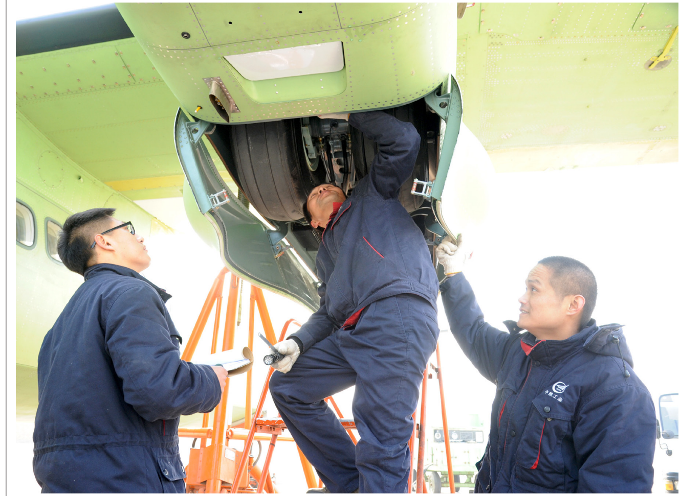
在中航工业西飞试飞站停机坪上,10多个架次的飞机在进行着发动机开车、液压、通电、起落架收放等各种试验,以及军检、排故和配合飞行。虽寒风刺骨,但紧张的工作现场却显得热火朝天。据调查室工作人员介绍,连日来,很多人每天工作都在12个小时以上,遇到任务紧急,他们早上6点多就赶到现场进行准备,晚上还要挑灯夜战。图为二大队工作人员在起落架收放试验中检查运动中的间隙。 本报通讯员 冯新胜 摄影报道
