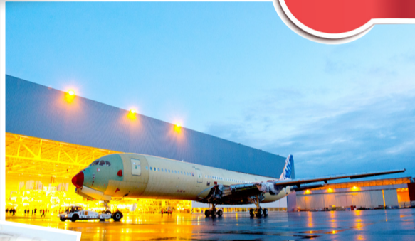
用于首飞测试的A350XWB已经完成总装。系统安装工作。这架飞机随后将进行一系列的生产和取证测试、完成喷漆及发动机安装,为首飞做准备。
