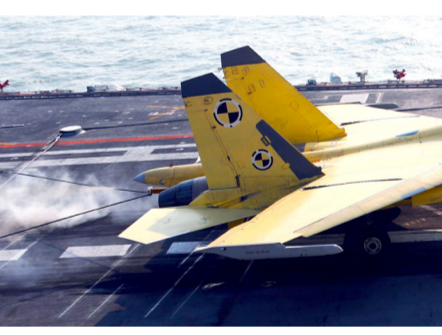
歼15舰载机尾钩挂上阻拦索的瞬间。 查春明 摄
